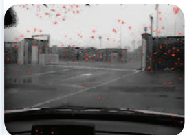
Détection de la pluie par traitement d'images
