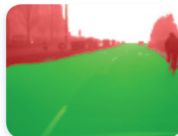
Extraction de l'espace navigable à partir d'une seule image par temps de brouillard
